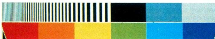
Bild 3. Ein Ausschnitt des Testbildes auf dem Commodore 1081. Hier sieht man gut die Auflösung an den senkrechten Strichen und die Farbdarstellung.
